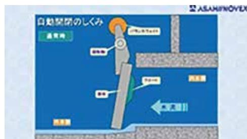
通常時において扉体は斜めに外水側に開いており、内水が緩やかに排水されるようになっております。扉体の上方に回転軸があり、さらにその上にバランスウェイトがついております。回転軸は扉体の重心より少し前に位置しておりまして、その上のバランスウェイトと扉体の重量は扉体が約8度開いた状態でバランスが取れ、静止するように設計されております。扉体の裏側にはフロートが付いております。バランスウェイトは上から下へのモーメントが働き、水に浸かった時のフロートは下から上へのモーメントが働きます。この構造は重い鉄の扉を軽い力で開閉できるようにアシストすることを狙って考案されたものです。
