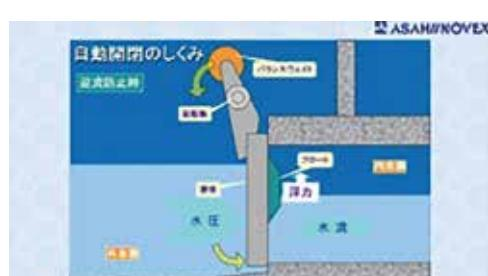
大雨が降って川の水位が上がり、外水が逆流し始めると外水の水圧の方が内水の水圧を上回ることになりますので、扉体は図のように完全に閉じます。バランスウェイトとフロートのモーメントに注目してください。
