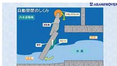
内水がたくさんになりますと、水流が扉体を外水側に水圧をかけますので扉体とバランスウェイトのバランスは扉体を開く方に作用し、フロートはその動きを助長するように働きます。
