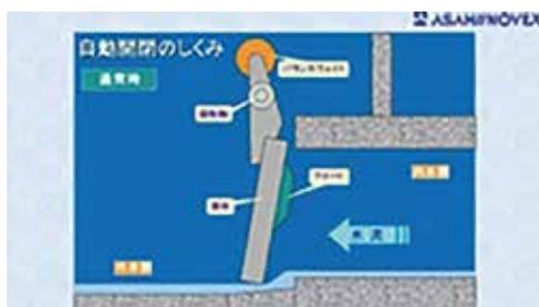
通常時において扉体は斜めに外水側に開いており、内水が緩やかに排水されるようになっております。扉体の上の方に回転軸があり、さらにその上にバランスウェイトがついております。回転軸は扉体の重心より少し前に位置しております。その上のバランスウェイトと扉体の重量は扉体が約8度開いた状態でバランスが取れ、静止するように設計されております。扉体の裏側にはフロートが付いております。バランスウェイトは上から下へのモーメントが働き、水に浸かった時のフロートは下から上へのモーメントが働きます。この構造は重い鉄の扉を軽い力で開閉できるようにアシストすることを狙って考案されたものです。
